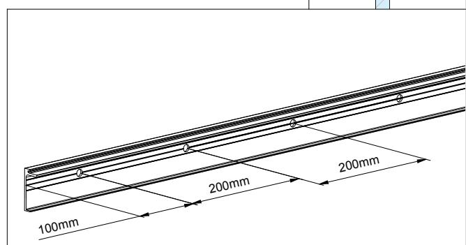
L'installazione dei Fluido 70 e Fluido 150 non necessita di forature sul vetro. La instalación del "Fluido 70" y de "Fluido 150" no necesita hojas en el cristal.
