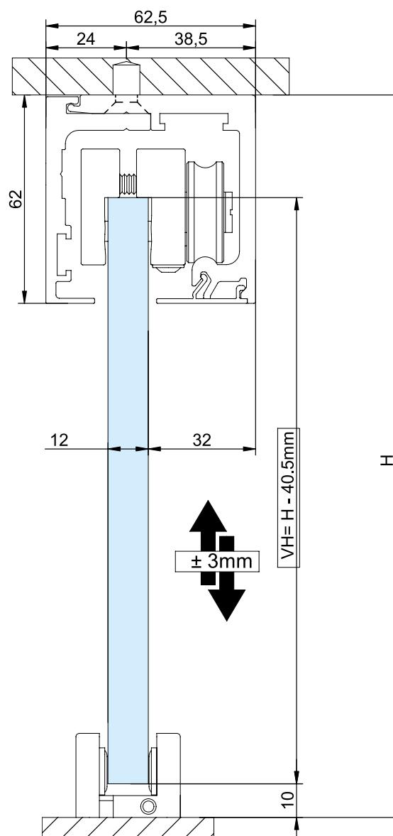
L'installazione dei Fluido 70 e Fluido 150 non necessita di forature sul vetro. La instalación del "Fluido 70" y de "Fluido 150" no necesita hojas en el cristal.
