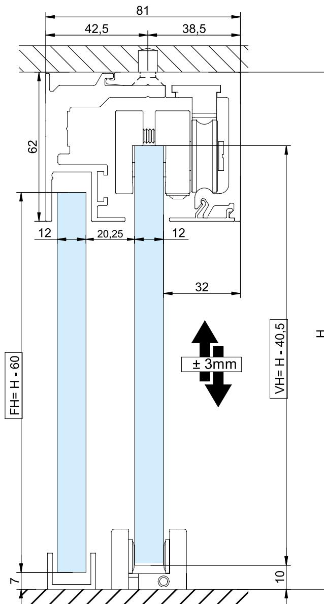
L'installazione dei Fluido 70 e Fluido 150 non necessita di forature sul vetro. La instalación del "Fluido 70" y de "Fluido 150" no necesita hojas en el cristal.
