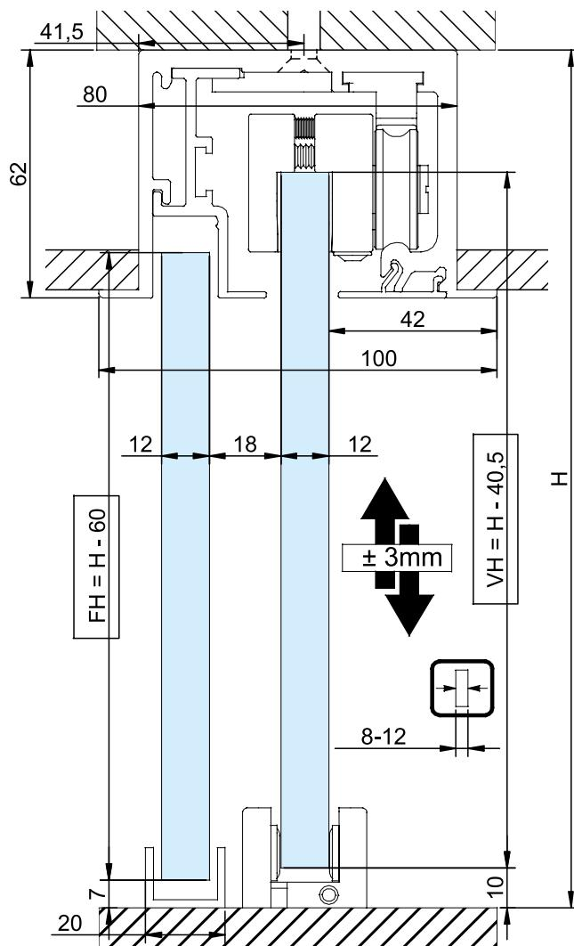
L'installazione dei Fluido 70 e Fluido 150 non necessita di forature sul vetro. La instalación del "Fluido 70" y de "Fluido 150" no necesita hojas en el cristal.
