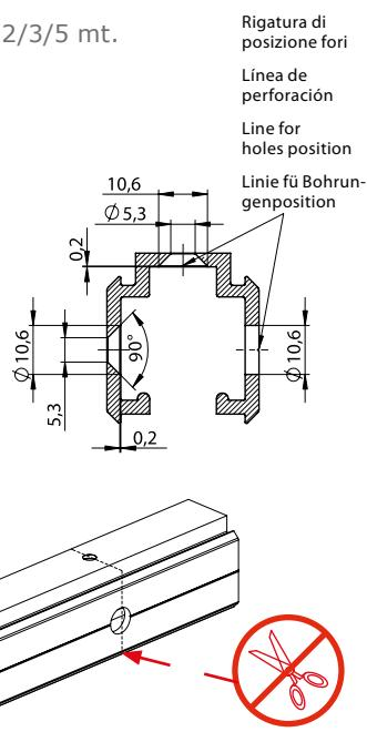
Evitare di accorciare la barra in prossimità dei fori - No acorte la barra cerca de los agujeros. - Avoid to make the bar shorter near the holes - Die Schiene in der Nähe der Bohrungen nicht abkürzen.
