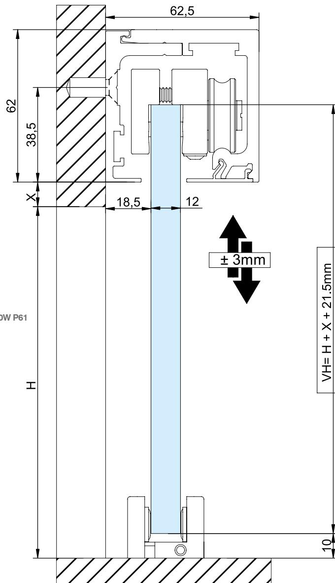
L'installazione dei Fluido 70 e Fluido 150 non necessita di forature sul vetro. La instalación del "Fluido 70" y de "Fluido 150" no necesita hojas en el cristal.
