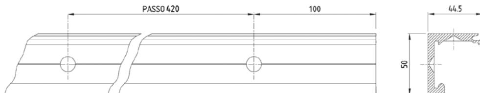
LE BARRE VENGONO FORNITE CON PREFORATURE CIECHE A PASSO 400 PER IL FISSAGGIO A MURO (PARETE O SOFFITTO) - LA BARRA VIENE MANUFACTURADA CON AGUJEROS CIEGOS DE PASO 400 PARA LA FIJACIÓN (PARED O TECHO) - THE BARS ARE SUPPLIED WITH BLIND DRILLING BY SPACING 400 FOR FIXING WALL (WALL OR CEILING) - DIE STANGEN SIND MIT SACKLÖCHER MIT ABSTAND 400 FÜR DIE WANDFIXIERUNG (WAND ODER DECKE) GELIEFERT.
