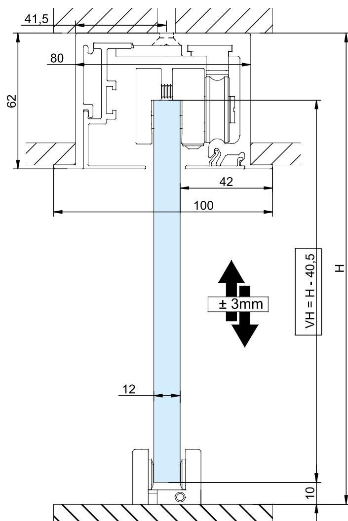
L'installazione dei Fluido 70 e Fluido 150 non necessita di forature sul vetro. La instalación del "Fluido 70" y de "Fluido 150" no necesita hojas en el cristal.
