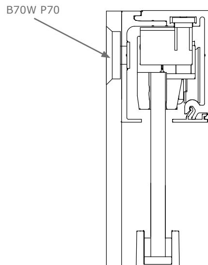
L'installazione dei Fluido 70 e Fluido 150 non necessita di forature sul vetro. La instalación del "Fluido 70" y de "Fluido 150" no necesita hojas en el cristal. The installation of Fluido 70 and 150 does not need holes on the glass. Die Systeme Fluido 70 und 150 benötigen keine Glasbearbeitung.
