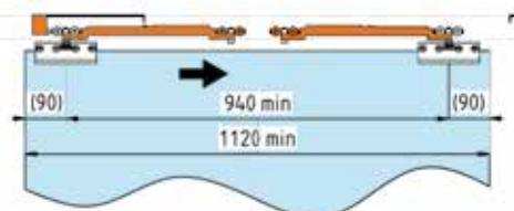
Porta doppia con soft-close in chiusura - Doble puerta con cierre suave "soft-close" en cierre - Double door with soft-close at closing - Doppeltür mit Soft-Close beim Schließen
