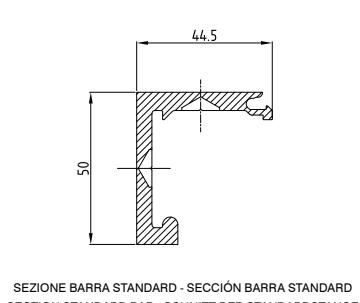
SEZIONE BARRA STANDARD - SECCIÓN BARRA STANDARD
